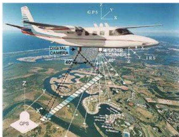
**Ilustração 10: Execução de voo apoiado com GNSS. Constelação de satélite e GNSS de solo.**
